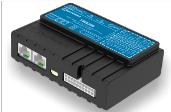
Mit dem GPS-Sender FM63 werden FMS-Daten übertragen.
