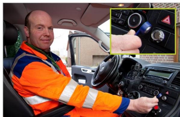
Stempeln direkt im Fahrzeug über RFID oder iButton Schlüssel.
