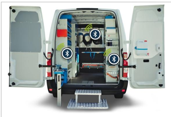
Mittels Beacon wird die Beladung über Bluetooth erkannt
